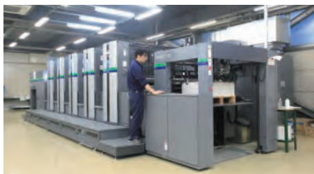
B1サイズ RMGT 1050ST-5(LED-UV乾燥装置、印刷品質検査装置搭載)
